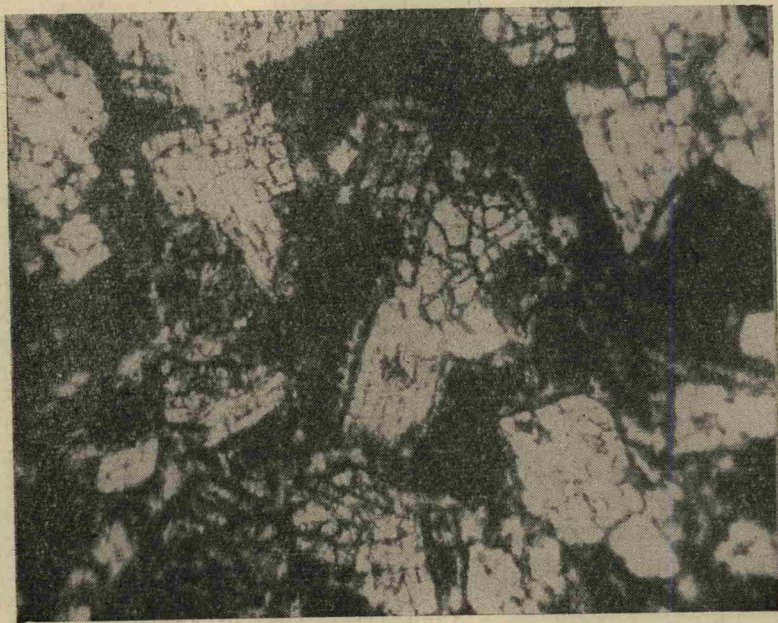
Рис. 2. Обр. 507. Кристаллы пироксена в слабо измененной основной массе с перекристаллизованным карбонатом. P=25 кбар, T=1100-900^{\circ}\text{C} , \times 100 , ник. ||.
